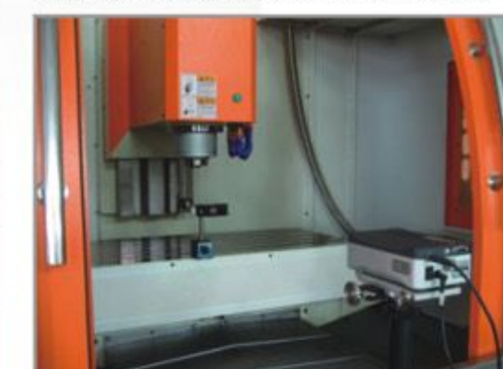
以精密的激光儀來保證每台機器的定位及重複定位精度。精確的對螺距及背隙補償。最新款 XL-80 Renishaw 激光干涉儀。
