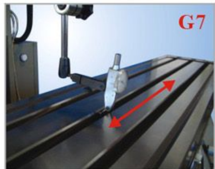
工作臺縱向移動對中央或基準T形槽的平行度 Parallelism of table longitudinal movement to T-slot surface 0.015/300mm
