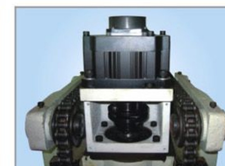
高速伺服馬達配合台灣聯動器直接聯結滾珠導螺桿, 背隙最少, 長保精度。
