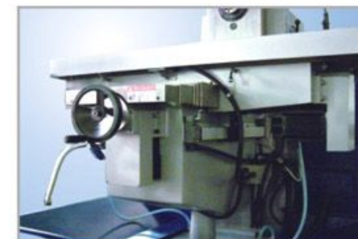
X、Y軸伺服電機 X & Y Servo Motor (Yaskawa)
