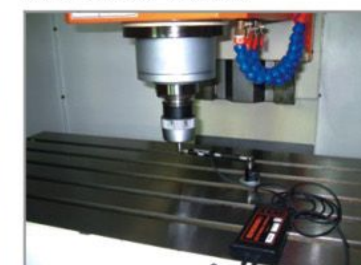
循環檢驗。校正真圓精度及機器幾何精度, 確保機床3D加工精度及圓滑度。
