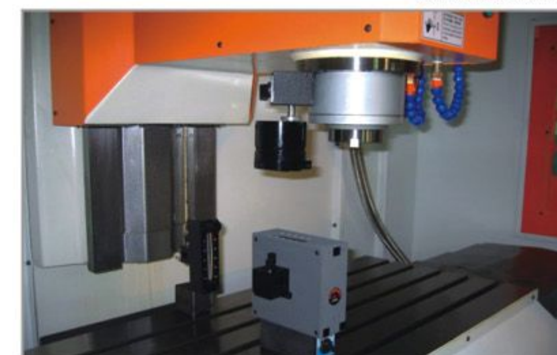
垂直度量測光學系統。保證3軸之間互相垂直。
